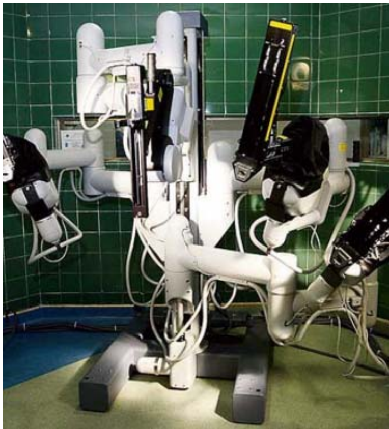
Los cuatro brazos robóticos del sistema quirúrgico Da Vinci son dirigidos por el cirujano desde otra consola
